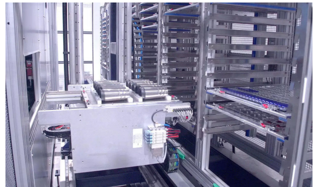
Paletta kezelés, mozgatás a speciális kialakítású robottal.
