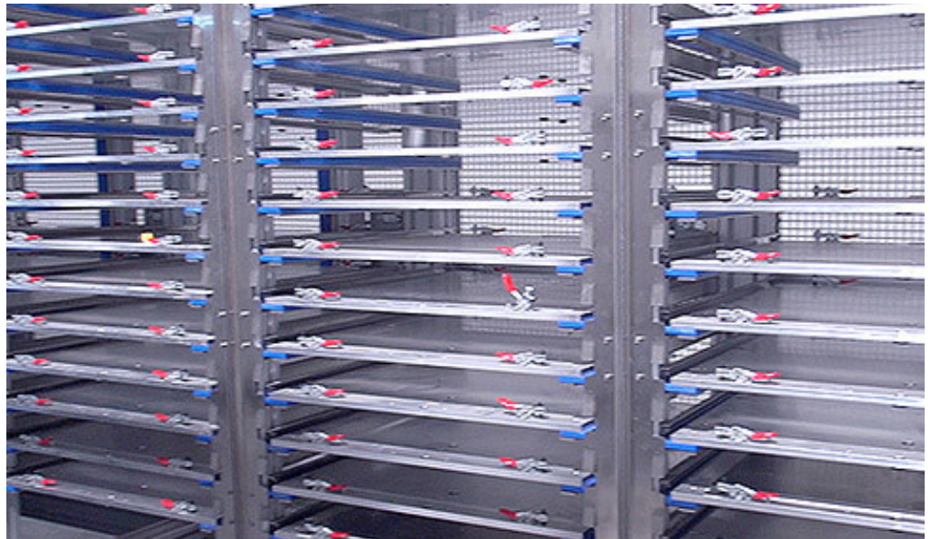
A termékek tárolása a palettás, magazinokon, amiken a jelölés is történik.
