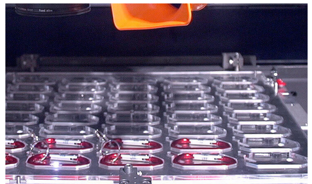
Paletta, nem teljesen feltöltött, a vezérlés pontosan tudja, melyik fészkekben kell jelölni, és melyikben nem.
